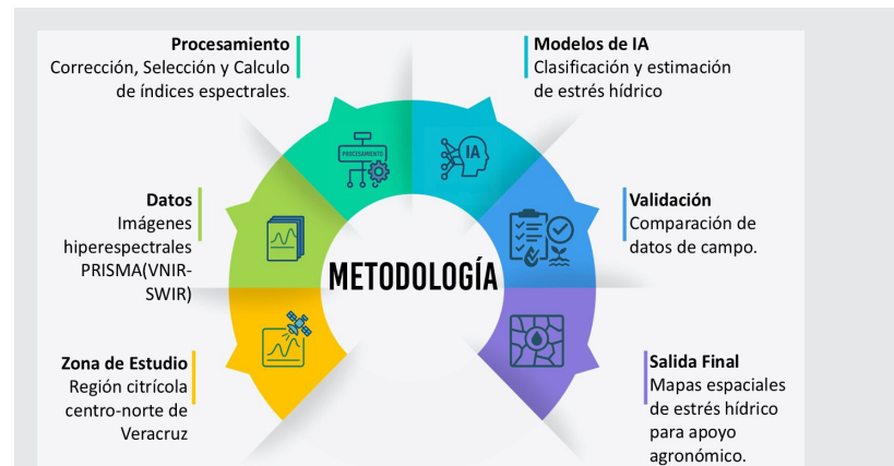
Figura 4. Flujo metodológico propuesto para el monitoreo del estrés hídrico en cultivos de cítricos a partir de imágenes hiperespectrales PRISMA e inteligencia artificial.
